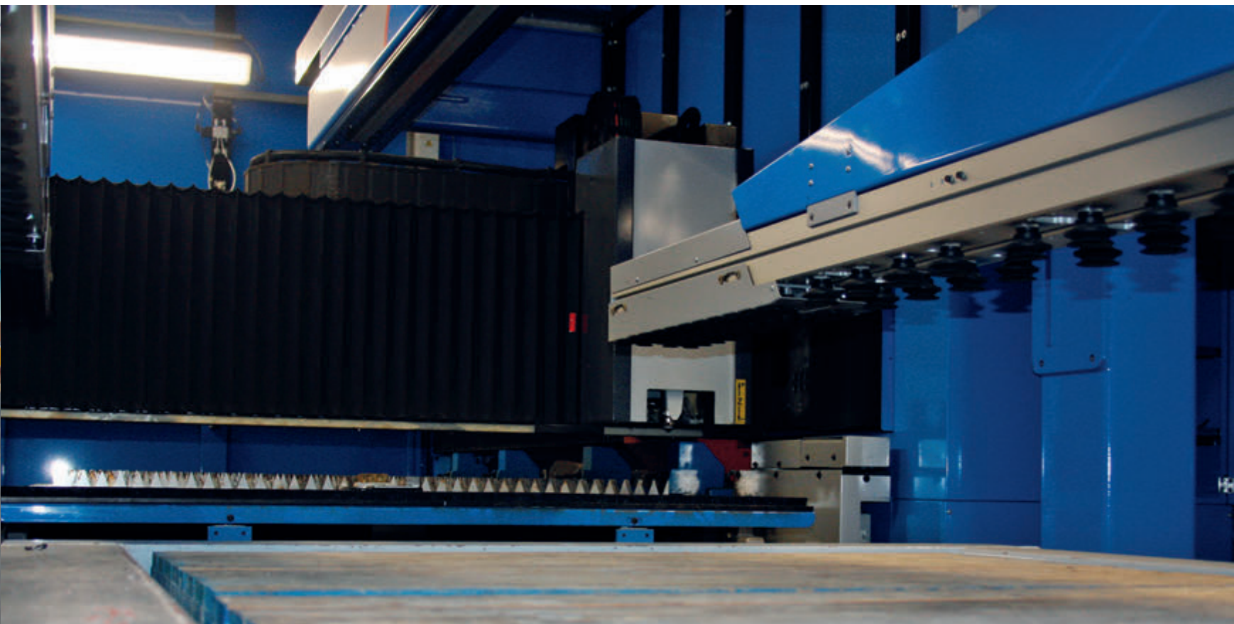
Night Train integra anche il sistema di taglio laser fibra 2D Prima Power Laser Genius 1530 equipaggiato con una sorgente fibra da 6 kW e robot di impilaggio automatico per macchine laser LST.
